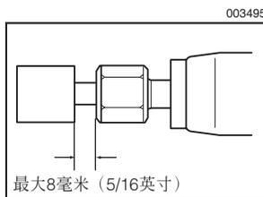
尖点磨轮的安装位置距离筒夹螺母不应超过 8 mm。
