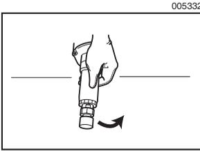
在尖点磨轮与工件无任何接触时开启工具，等待砂轮运转速度达到全速。然后将尖点磨轮与工件轻轻接触。为了获得良好的磨光效果，应慢慢的将工具向左侧移动。
