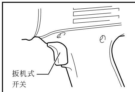
\* 注意：要插电以前，须先检查工具的开关操作是否圆滑，扣上扳机再放松，扳机开关是否能够弹回原位（关闭）。
